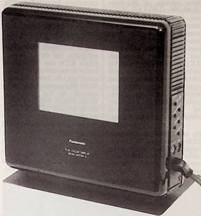
6 Inch 'Beam Matrix Color Flat Panel' beeldscherm dat Matsushita in april 1989 introduceerde.
